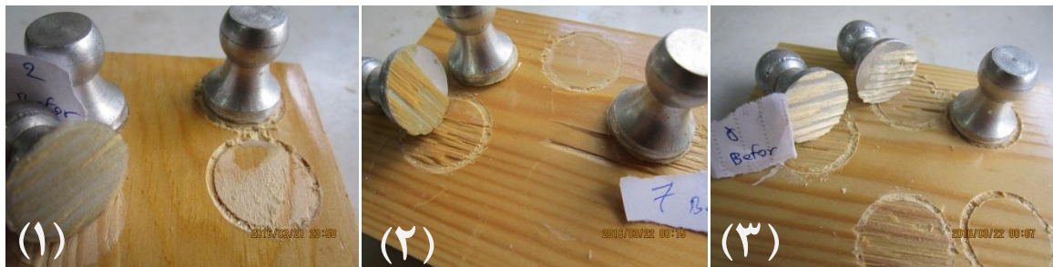
شکل ۵- سطح شکست پوشش‌های نانوکامپوزیتی حاوی ۰/۵ درصد سریم (۳)، ۰/۲۵ درصد سربا همراه با ۲ درصد سیلیس (۲) و پوشش بدون نانوذره (۱) در اثر آزمون چسبندگی کششی
