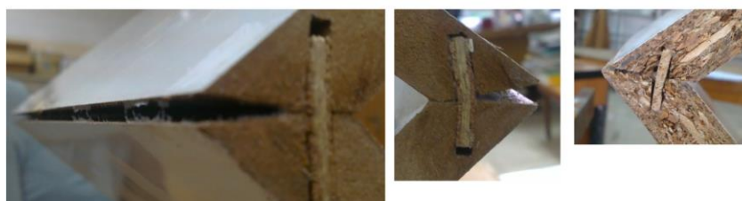
شکل ۴- مد شکست نمونه‌ها زیر بار فشاری
